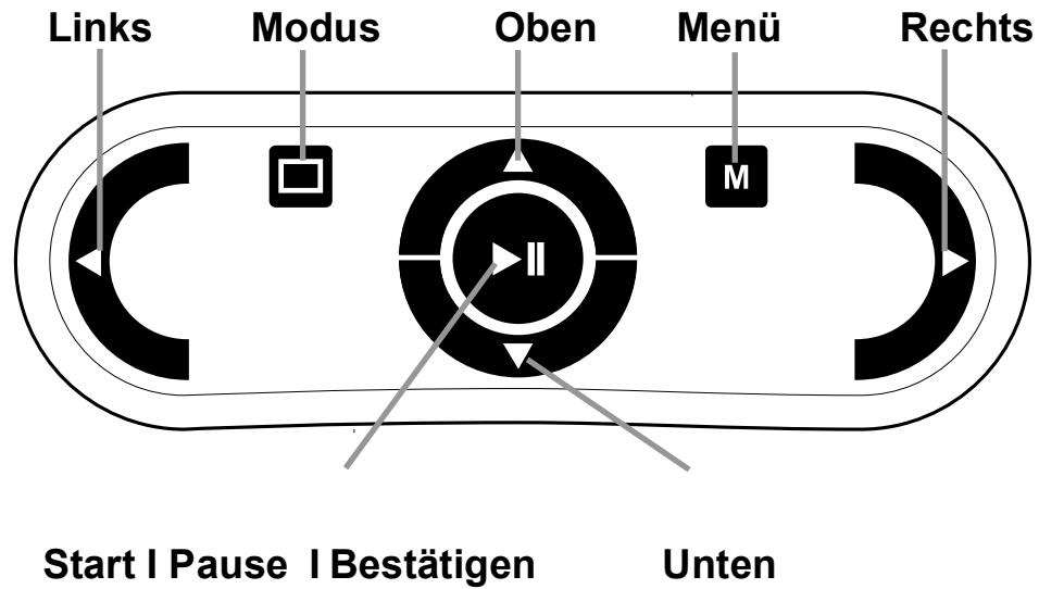
Start/Pause-Taste: Runde Taste in der Mitte der Tastatur, um das automatische Vorlesen anzuhalten und wieder fortzusetzen. Drücken und halten Sie diese Taste für 2 Sekunden, so wird das aktuelle Wort buchstabiert. Drücken Sie die Start/Pause-Taste im Menü, so gelangen Sie durch die
